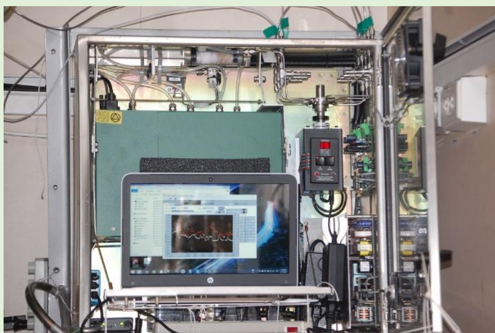
Fotos do equipamento utilizado para a coleta de dados contínuos de fração molar de \text{CO}_2 na água do mar, ao longo dos cruzeiros, instalado no Navio Polar Almirante Maximiano, em um cruzeiro para o Norte da Península Antártica.
