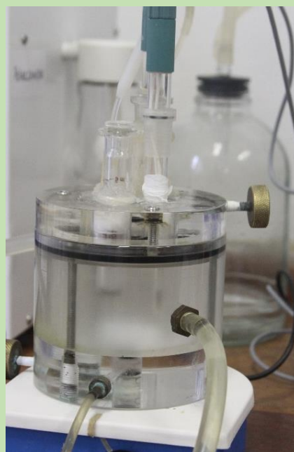
Fotos do equipamento utilizado para as análises de Alcalinidade Total e Carbono Inorgânico Dissolvido Total nas amostras de água do mar, quando feitas em laboratório.
